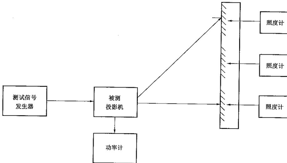
图 A.3 投影机投影光效测试系统框图
