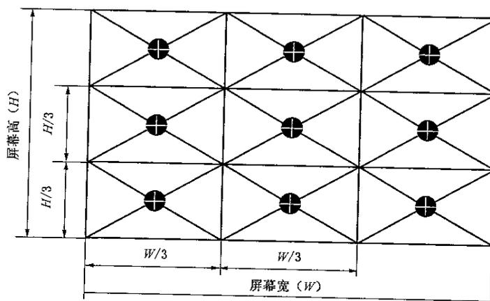
图 A.2 九点照度测试位置示意图
